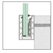
Крепление стеклянных полотен осуществляется по нижнему краю при помощи опорного зажимного профиля. Сам зажимной опорный профиль надежно крепится к основанию либо вертикально в пол (видимый или скрытый монтаж), либо сбоку в торец основания.
